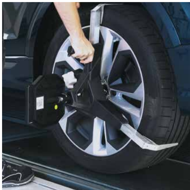
Q.Grip: 牢固安全地夹持车轮
